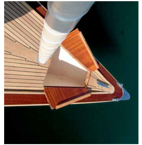
Die Klampe vor dem Ankerkasten dürfte mit zwei auf Slip geführten Festmachern etwas klein sein.
