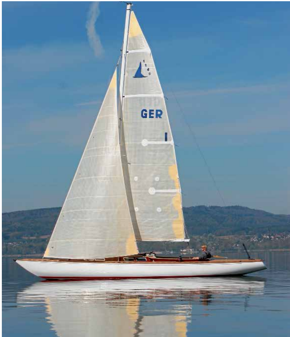
Handliches Rigg ohne Backstagen mit moderatem Genua-Unterliek und zwei durchgehenden Topplatten.
