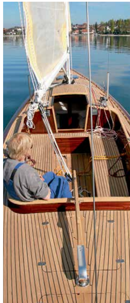
Geräumiges Cockpit mit hohem Süllrand und Brückendeck.
