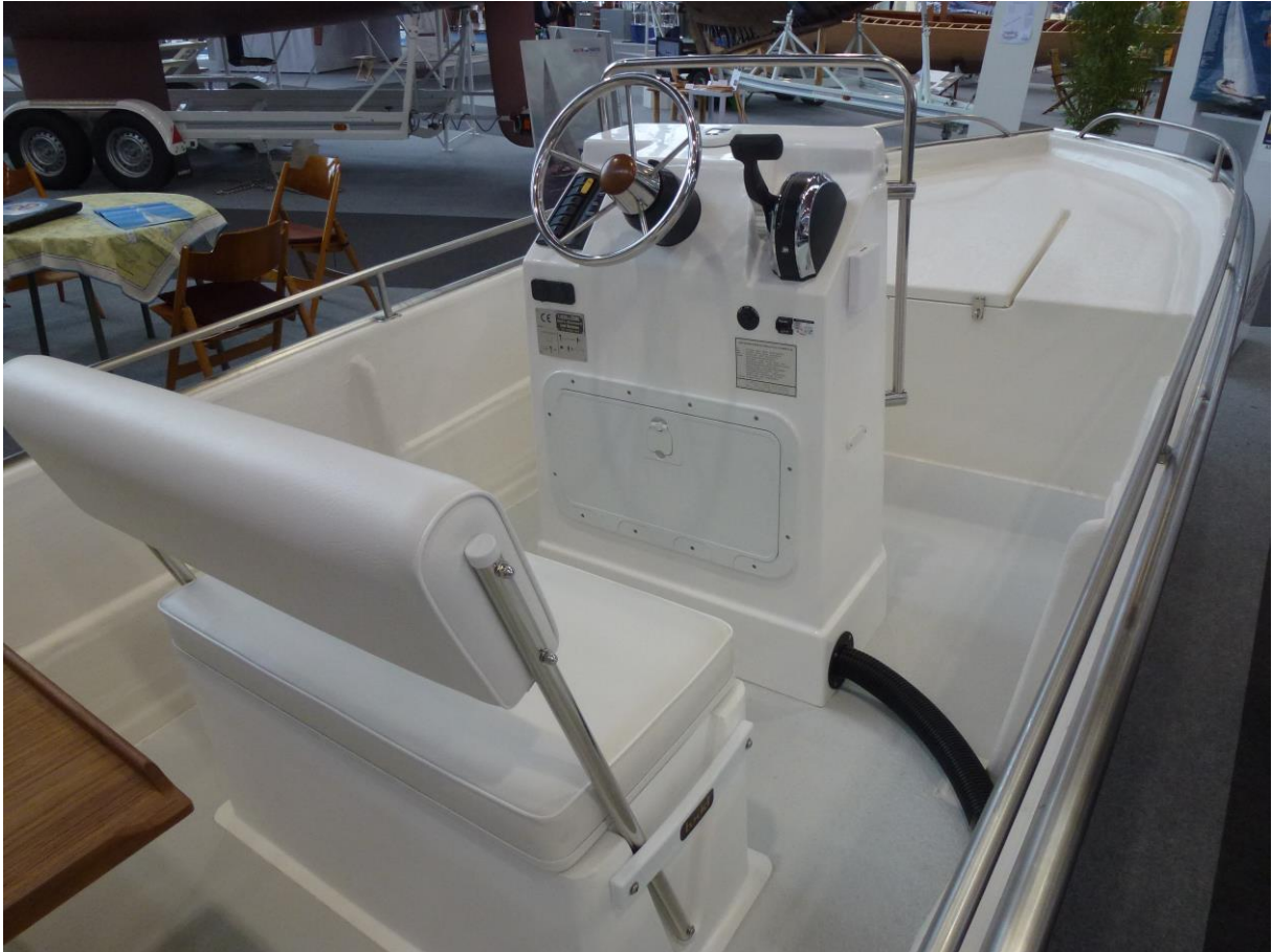
fetter Steuerstand mit Schaltung hydraulischer Steuerung Elektro-Paneel
