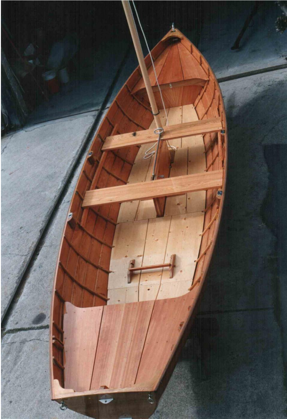
In traditioneller geklinkerter Bauweise in Lärche. Hier mit Segeleinrichtung.
