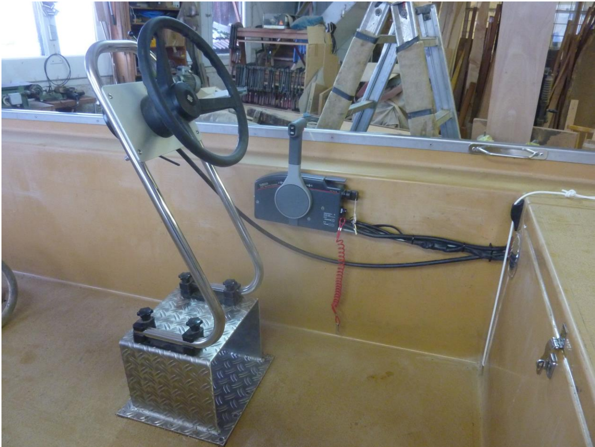
kleiner einfacher Steuerstand mit seitlicher Schaltung
