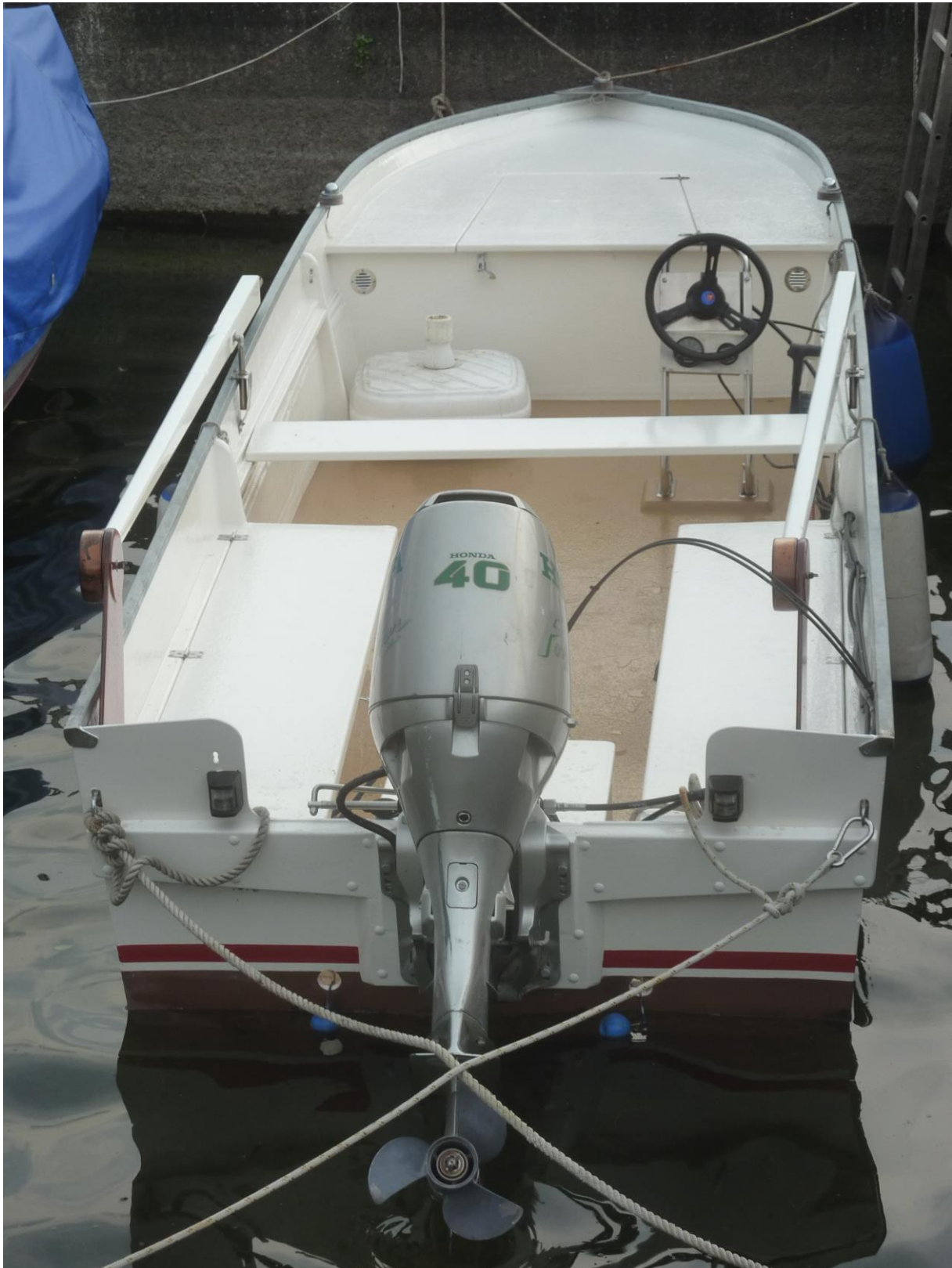
einfacher Steuerstand mit Schaltung an der Bordwand
