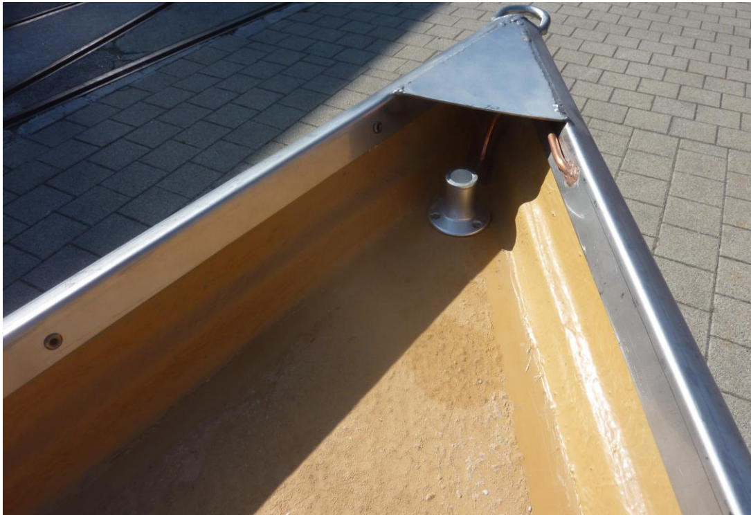
Kraftstoffleitung in vorderen Stauraum gelegt
