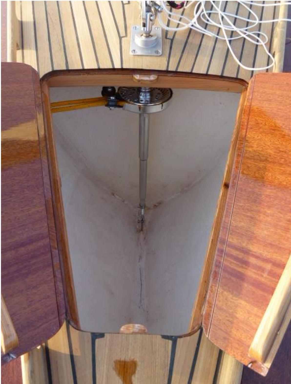
Ankerkasten mit Endlos Fockroller
